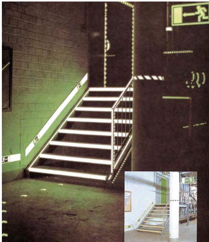
In caso di mancanza improvvisa di luce, l'elevato effetto luminescente permette di segnalare, anche nel buio più completo, uscite, soglie, scale, corridoi, quadri elettrici, equipaggiamenti di sicurezza o antincendio, ostacoli. Le strisce alternate rosse o verdi rendono segnaletico il nastro anche in normali condizioni di luce.
