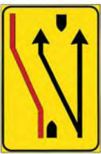
F41130 Fig 411c Segnale di corsie chiuse
