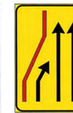
F41121 Fig 411b Segnale di corsia chiusa (chiusura corsia di sinistra)
