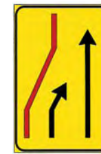
F41111 Fig 411a Segnale di corsia chiusa (chiusura corsia di sinistra)
