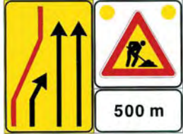
F39902 Fig 399b Presegnale di cantiere mobile
