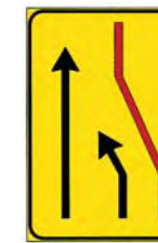
F41112 Fig 411a Segnale di corsia chiusa (chiusura corsia di destra)
