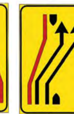
F41303 Fig 413c Segnale di corsie chiuse
